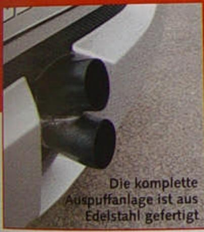
Die komplette Auspuffanlage ist aus Edelstahl gefertigt
