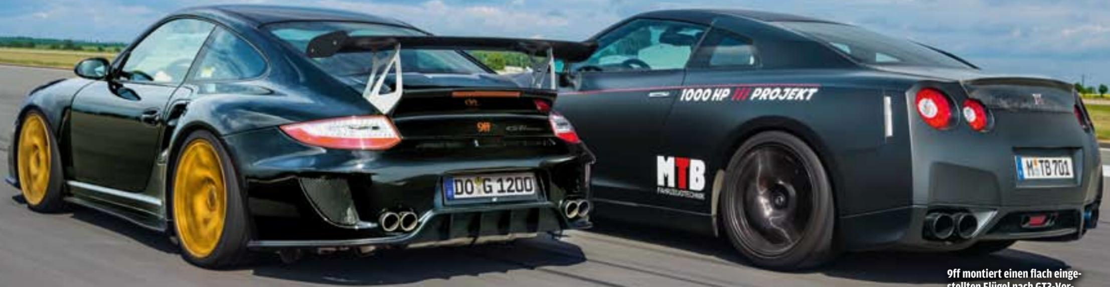
9ff montiert einen flach eingestellten Flügel nach GT3-Vorbild; MTB entfernt den Serien-spoiler mittels Carbondeckel
