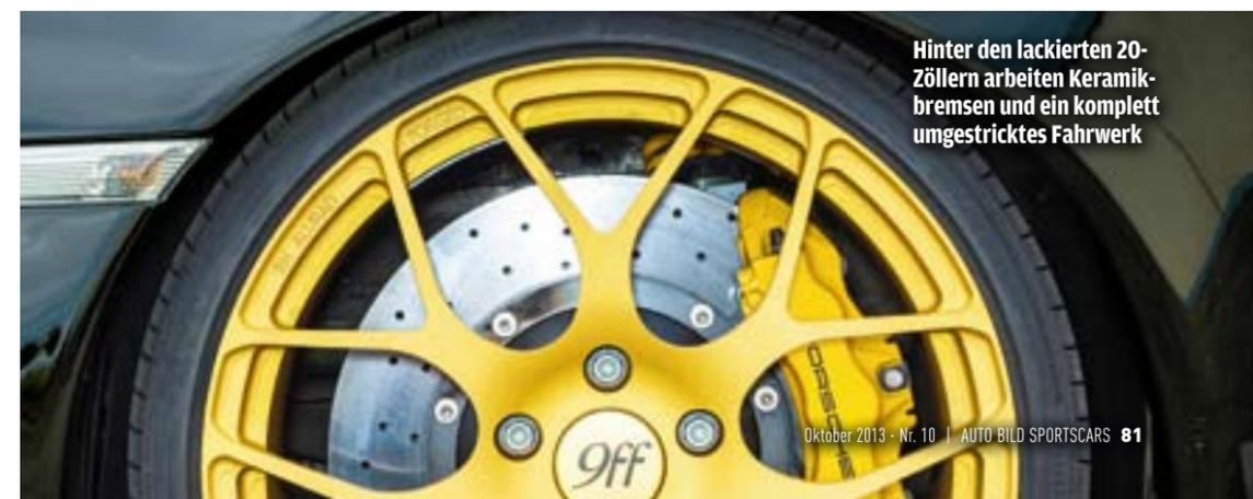
Hinter den lackierten 20-Zöllern arbeiten Keramikbremsen und ein komplett umgestricktes Fahrwerk
